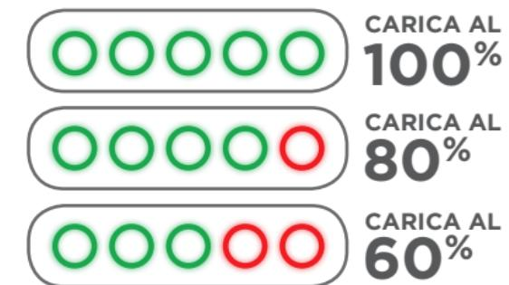
FIGURA 11: ESEMPIO DI SEQUENZA DI LAMPEGGIO INDICANTE IL LIVELLO DI CARICA DELLA BATTERIA
