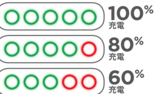
図5: バッテリー残量を表示するランプの点滅の例
