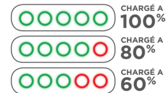
FIGURE 11 : EXEMPLE DE SÉQUENCE DE CLIGNOTEMENT
