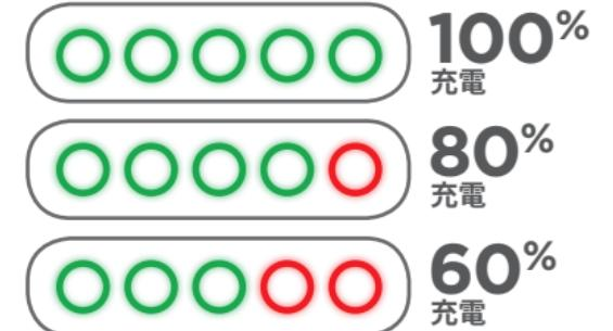
図11: バッテリー残量を表示するランプの点滅の例
