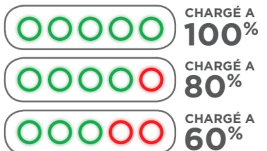
FIGURE 5 : EXEMPLE DE SÉQUENCE DE CLIGNOTEMENT INDICUIT LE NIVEAU DE CHARGE DE LA BATTERIE
