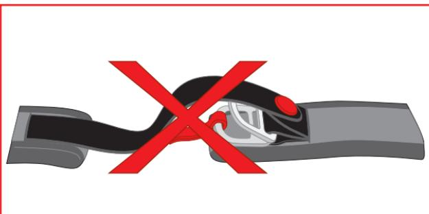
**Obs. BOTÕES/VELCRO COLOCADOS NO SISTEMA DE RETENÇÃO NÃO Têm FUNÇÃO DE FIXAÇÃO, MAS SOMENTE PARA EVITAR QUE SE DESARRUMEM COMO VENTO: NÃO DEVEM SER UTILIZADOS COMO ALTERNATIVA PARA AMARRAR A CORREIA.**
