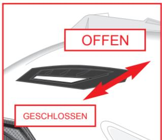
Zum Öffnen/Schließen der Belüftungselemente den Schieber solange verschieben, bis das Einrastgeräusch zu vernehmen ist, welches die Blockierung des Schiebers in der korrekten Position anzeigen.
