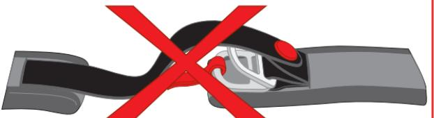
**N.B. DRUCKKNOPF/KLETTEN AUF DEM RÜCKHALTUNGSSYSTEM DIENEN NICHT FÜR DIE BEFESTIGUNG, SONDERN SIND NUR GEGEN DAS FLATTERN. SIE DÜRFEN NICHT ALS ALTERNATIVE FÜR DAS ANSCHNALLEN DES RIEMENS BENUTZT WERDEN.**
