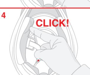
Das Plastikband zwischen der Schale aus EPS und der Außenkalotte in Pfeilrichtung einführen und die Druckknöpfe (4) zusammendrücken. Prüfen, ob die Wangenpolster perfekt am Helm befestigt sind.
