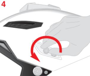
Zum Abnehmen der Plastikplaketten die Schrauben von einer Helmseite ausgehend von Hand oder unter Zuhilfenahme eines Schraubenziehers losschrauben (2). Den Vorgang auf der anderen Seite wiederholen und anschließend mit dem Einsetzen des Daches fortfahren.
