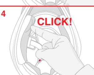
Introduire la bande en plastique entre la coque EPS et la calotte externe de façon à suivre la direction de la flèche et déclencher les boutons-pressions de connexion (4). Vérifier que les coussins de joue sont parfaitement fixés au casque.
