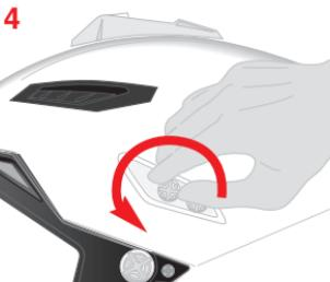
Para extraer las plaquetas de plástico, comenzando por uno de los lados del casco, desatornillar en forma manual o con ayuda de un destornillador los tornillos (2). Repetir la operación del otro lado y proceder luego a las operaciones de colocación de la visera.
