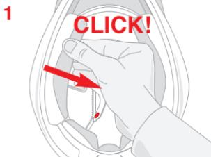
Die Wangenpolster zum Abnehmen an der Vorderseite in der Nähe des Kinnschutzes greifen und in Pfeilrichtung ziehen, um sie von den Druckknöpfen zu lösen (1).
