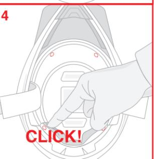
Para extraer la cofia, desenganchar los dos botones automáticos que se encuentran en la zona anterior (1) y los dos que se encuentran en la zona posterior del casco (2). Extraer la cofia del casco.
