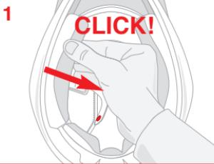
Para desmontar los acolchados laterales, tomarlos por la parte anterior cerca de la mentonera del casco y tirar en la dirección que indica la flecha para liberarlos de los botones automáticos (1). Extraer la banda de plástico que se encuentra entre la calota externa y el forro de EPS siguiendo la dirección de la flecha, desmontar los acolchados laterales haciendo pasar la tira de cierre a través del orificio y extraerlos (2).
