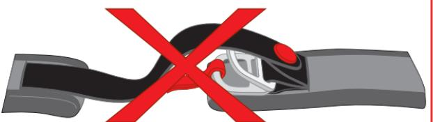
**N.B. PULSANTI/VELCRO POSTI SUL SISTEMA DI RITENZIONE NON HANNO FUNZIONE DI FISSAGGIO MA SOLO DI ANTI-SVENTOLIO: NON VANNO UTILIZZATI IN ALTERNATIVA PER ALLACCiare IL CINTURINO.**
