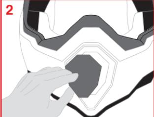
Placer l'outil fourni dans la fissure présente sur le bord de la prise d'air nez (2) et s'en servir de levier pour enlever la prise d'air de la calotte.
