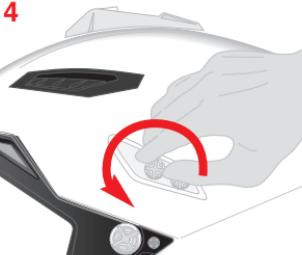
Para remover as placas em plástico, partindo de um lado do capacete, desenrosque manualmente ou com uma chave de fenda os parafusos (2). Repita a operação no outro lado e proceda depois com as operações de instalação da cobertura.
