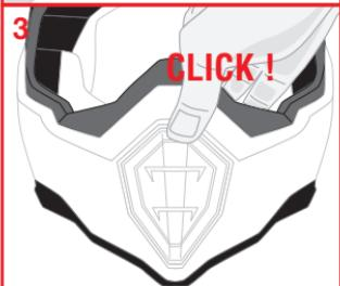
Pour remonter la prise d'air nez, placer dans le trou correspondant à la prise le filtre (3) en faisant attention à ce que les bords des deux coïncident avec ceux du trou dans la calotte.
