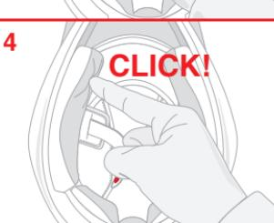
Inserire la bandella di plastica tra il guscio in EPS e la calotta esterna in modo da seguire la direzione della freccia e far scattare i bottoni automatici di connessione (4). Verificare che i guanciali siano perfettamente assicurati al casco.
