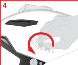
Per rimuovere le placchette in plastica, partendo da un lato del casco svitare manualmente o con l'aiuto di un cacciavite le viti in alluminio (2). Ripetere l'operazione dall'altro lato e procedere poi con le operazioni di installazione del tettuccio.
