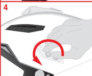
Pour démonter les plaquettes en plastique, en partant d'un côté du casque dévisser manuellement ou à l'aide d'un tournevis les vis (2). Répéter l'opération de l'autre côté et procéder ensuite aux opérations de remontage du petit toit.
