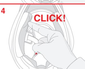
Colocar la banda de plástico entre el forro de EPS y la calota externa siguiendo la dirección que indica la flecha y liberar los botones automáticos de conexión (4). Verificar que los acolchados laterales se encuentren bien asegurados al casco.
